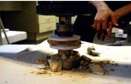
Komponentenprüfung – Mörtel mit Stempeldruckprüfung
