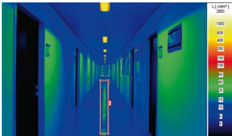
Die Leuchtdichtemessung zeigt, die deutlich veränderte Lichtwirkung im Vergleich zur ursprünglichen Ausstattung. (scharfe Schattenkanten auf Türhöhe). © MA39 - VFA / Lichttechniklabor
