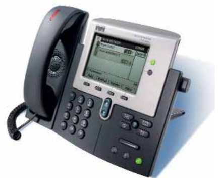
Internet-Telefonie ohne PC: spezielle IP-Telefone verfügen über ähnliche Komfort-Funktionen wie ISDN-Geräte. (Cisco)
