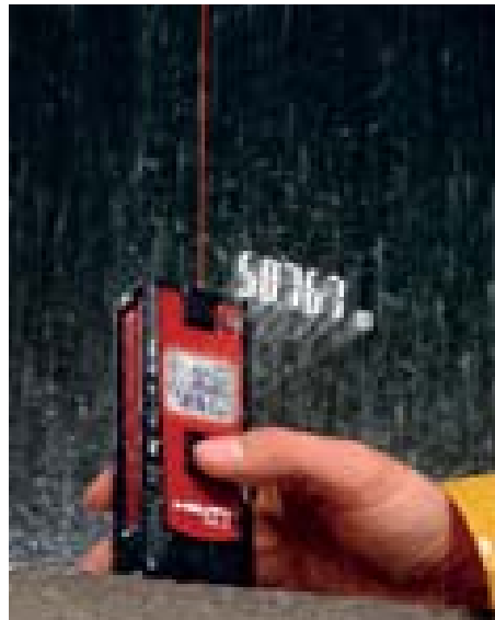
Das Gehäuse sollte „baustellentauglich“, sprich: stoß-, staub- und spritzwassergeschützt sein (Hilti)
