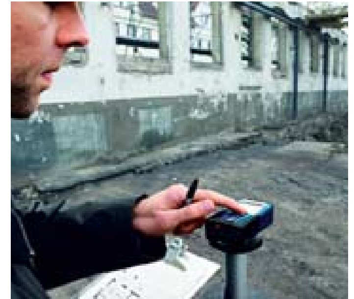
Beim Messen über größere Distanzen hinweg ist ein Stativ empfehlenswert (Bosch)
