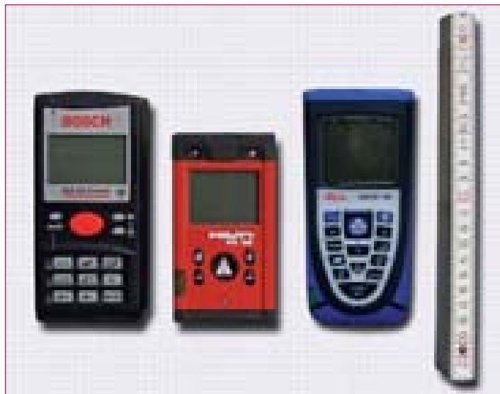
Drei Anbieter offerieren mittlerweile Laser-Distanzmessgeräte mit PC-Anschluss: Bosch, Hilti und Leica (MWM)
