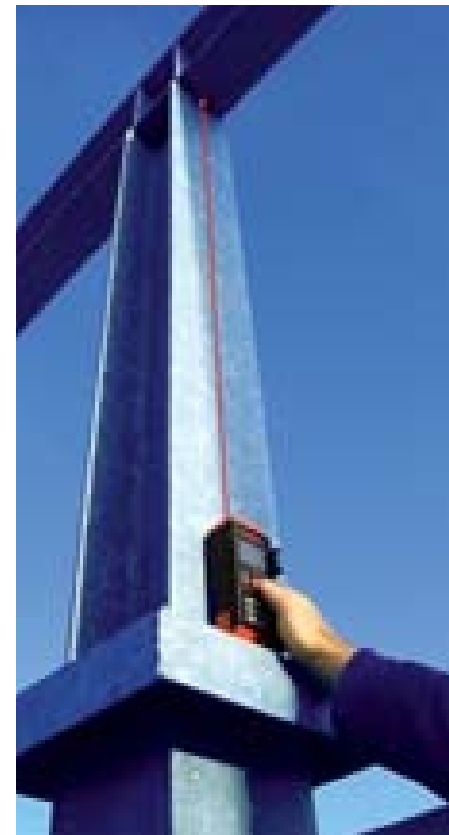
Wenn es um das präzise und schnelle Messen lichter Maße bzw. Höhen geht, sind Laser-Distanzmesser unschlagbar (Bosch)
