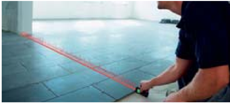
Boden nicht begehbar? Kein Problem: per Laserstrahl lassen sich wichtige Maße dennoch ermitteln (Leica Geosystems AG)
