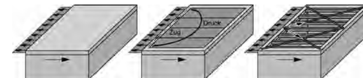
Gebäudeaussteifung – Wirkung von Deckenscheiben
