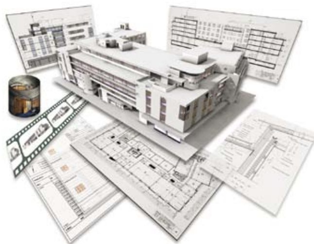
Modellieren statt zeichnen: Die automatische Generierung von Plänen und Visualisierungen ist nur einer der vielen Vorteile von BIM (Graphisoft).
