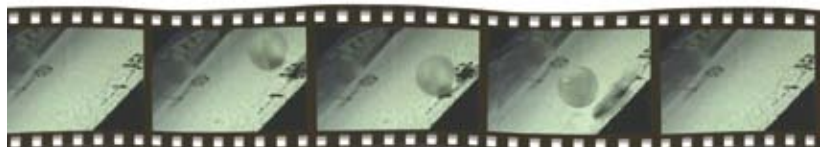
Die Carbon-Fassade von Capatect übersteht sogar Fünf-Zentimeter-Hagelschloßen ohne Beschädigungen.
